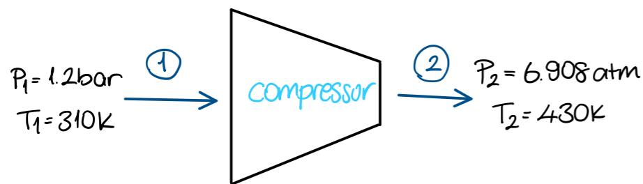
$$\dot{E}_1 = \dot{E}_2 \\ \dot{m}h_1 + W = \dot{m}h_2 + \dot{Q} -$$
